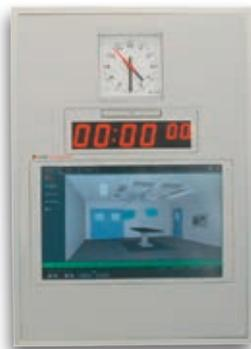
**SCP-TCP con pantalla táctil 22", reloj analógico, cronómetro digital**
